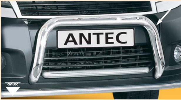
EU-pedestrian protection guard 60mm high (EU-certificate also valid in combination with 12F4041 or 12F4085) EU-Personenschutzbügel 60mm hoch (EU-Zertifikat auch gültig mit 12F4041 oder 12F4085) Stainless steel /Edelstahl 12F 4013
